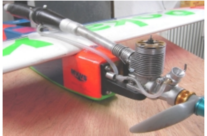
Antrieb für die Unlimited-Klasse: Getuneder MVVS 4,2 cm 3 Combat mit abgedrehtem Zylinderkopf und Eigenbau-Resonanzrohr
