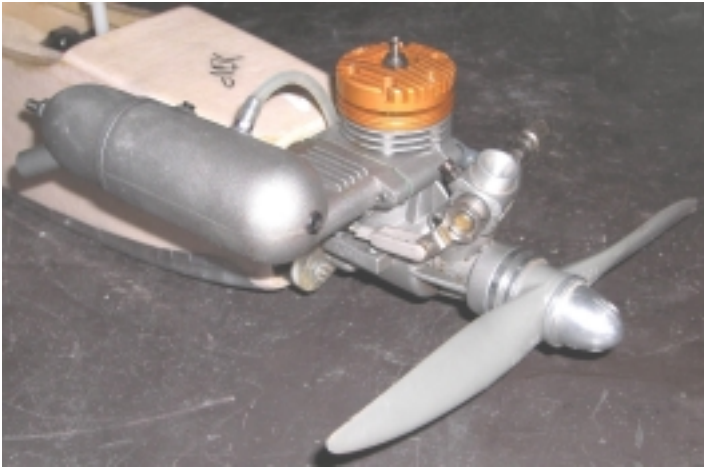
Maschine für einen Sport-Gnumpf: 25er GMS 2000, unbearbeitet aus der Schachtel
